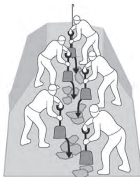
図4 組織的な掘り出し方法（V字コンベアメソッド）
